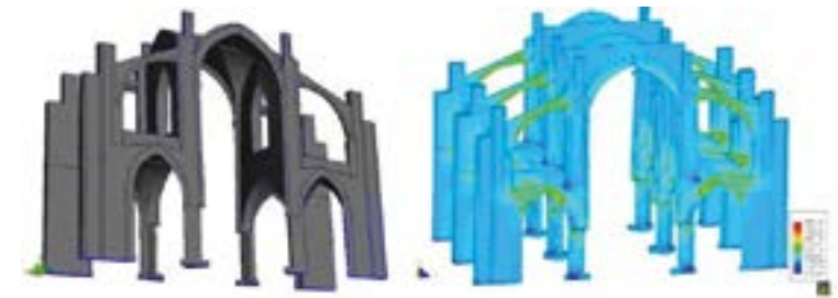
Figura 1.- Modelado numérico de las naves centrales de la catedral de Barcelona.
