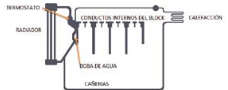
Figura 3. Sistema de refrigeración
