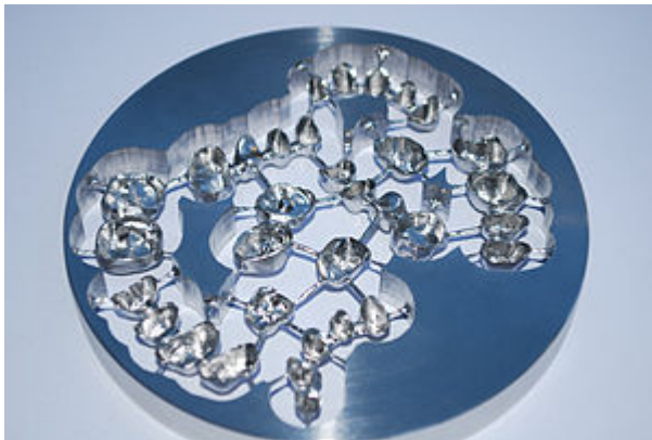
Figura 2. Disco de cromo-cobalto con coronas para implantes dentales mecanizados usando el software WorkNC Dental de fabricación asistida por computadora
